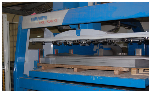
Program Lantek Expert Gold obsługuje m.in. wykrawarkę numeryczną FinnPower.
